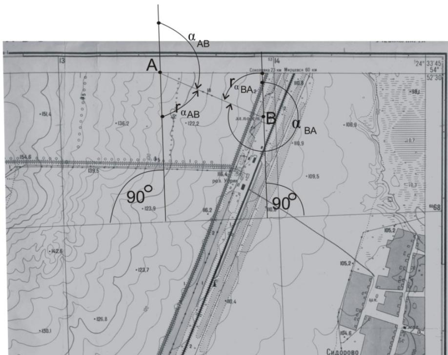
Рис. 2.8. Схема измерения углов ориентирования линии АВ в зональной системе плоских прямоугольных координат Гаусса-Крюгера по учебной топографической карте с номенклатурой листа У-35-38-А-в-3
