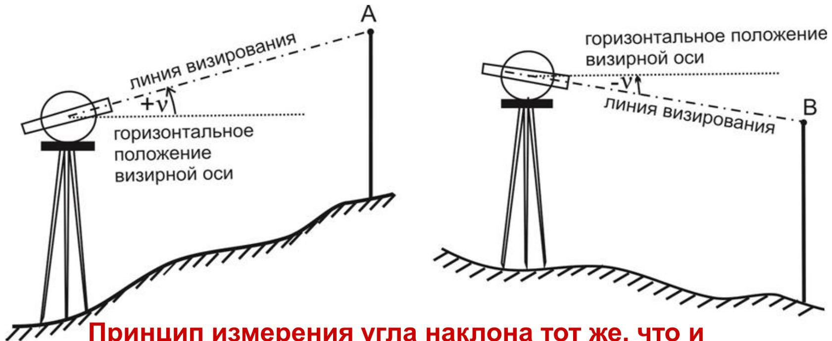
**Принцип измерения угла наклона тот же, что и горизонтального, т.е. значение угла равно разности двух отсчётов, полученных после визирования по двум сторонам угла.**
