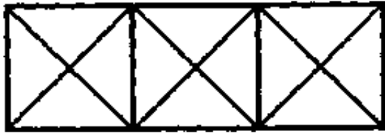
Схема цепочки треугольников сети трилатерации
