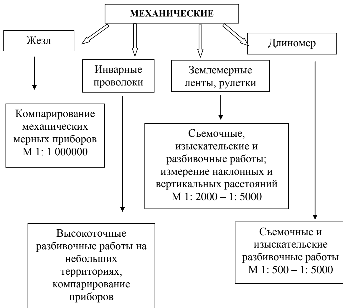
Механические приборы для измерения длин линий, применяемые в геодезии
