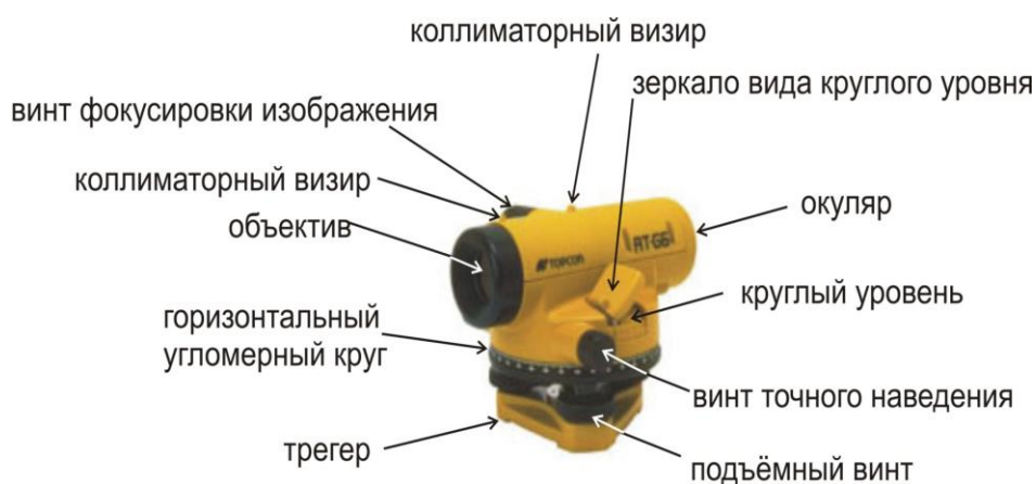
Рис. 1.2. Основные части оптического нивелира Topcon
