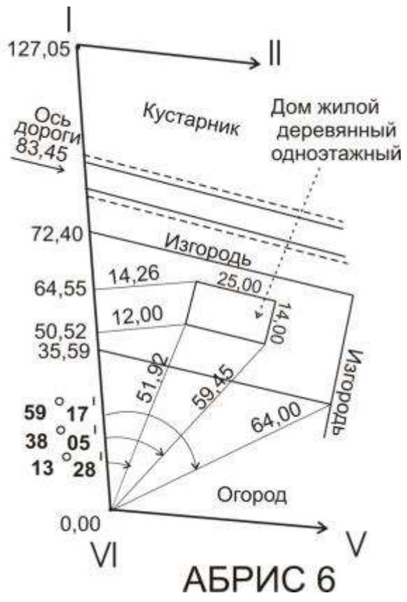
Рис. 6.4. Абрисы 5-6 теодолитной съёмки
