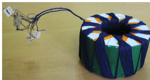
Рис. 3. Декада с намоткой типа секционная универсаль
