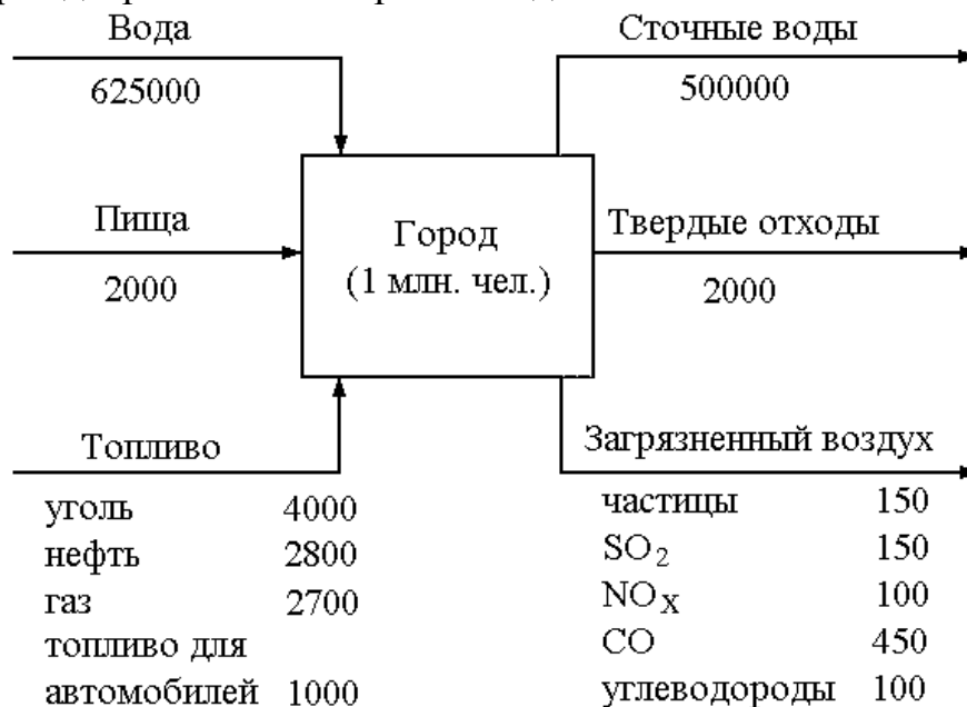
Рис. 3.5. Схема потребления ресурсов, сбросов и выбросов города населением 1 млн. чел. (в тоннах за сутки).
