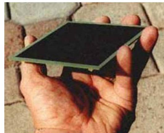
Пластина электролита с электродом
