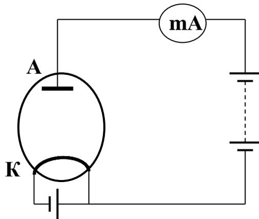
Если катод нагреть, пропуская ток через нить накала, и постепенно увеличивать напряжение между анодом и катодом лампы, то анодный ток будет увеличиваться, пока не достигнет насыщения
