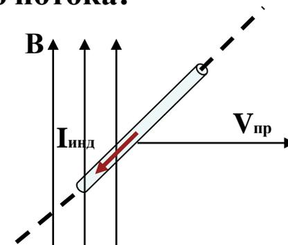
б) проводник покоится, движется магнитное поле (магнит, например)
