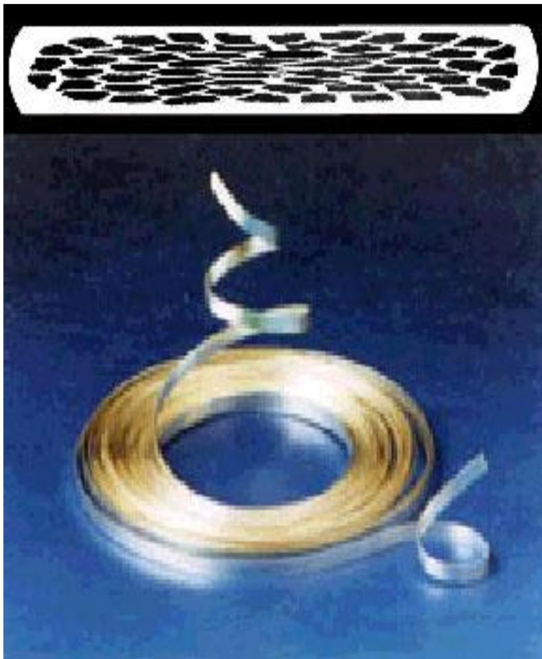
**Длинномерные композиционные сверхпроводники ленточного типа состоят из серебряной оболочки (или из сплава на основе серебра), внутри которой заключена 61 жила из ВТСП керамики фазы Bi-2223. Провода ленточного типа на основе этой системы можно использовать или при температуре жидкого азота (77 К) или, при более низкой, обычно, 30 К.**
