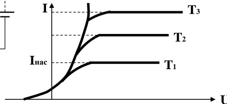
**Вольт-амперные характеристики** диода при различной температуре катода
