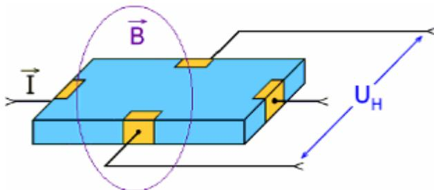
В магнитном поле с индукцией  $\vec{B}$  находится полупроводниковая пластинка, например, из арсенида иридия или антимонида индия, через которую протекает электрический ток  $I$ . Действие эффекта Холла заключается в том, что на боковых сторонах пластинки перпендикулярно направлению тока возникает разность потенциалов - напряжение Холла или ЭДС Холла  $U_H$ . Максимальное значение  $U_H$  принимает при совпадении вектора  $\vec{B}$  с нормалью к пластинке.
