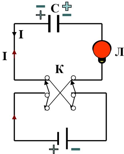
При длительном включении источника тока лампочка не горит, тока в цепи нет, так как конденсатор разрывает цепь.
