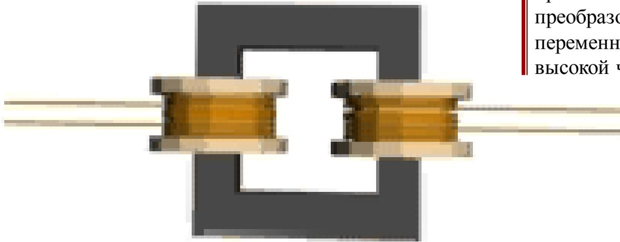
**Магнитопровод предназначен для усиления магнитной связи между обмотками.**
