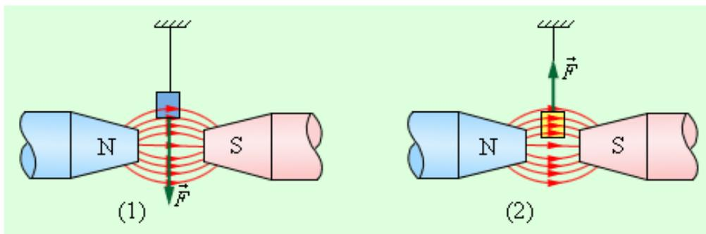
Образцы из пара- и диамагнетика, помещенные в неоднородное магнитное поле между полюсами электромагнита, ведут себя по-разному – **парамагнетики втягиваются в область сильного поля**, **диамагнетики – выталкиваются**
