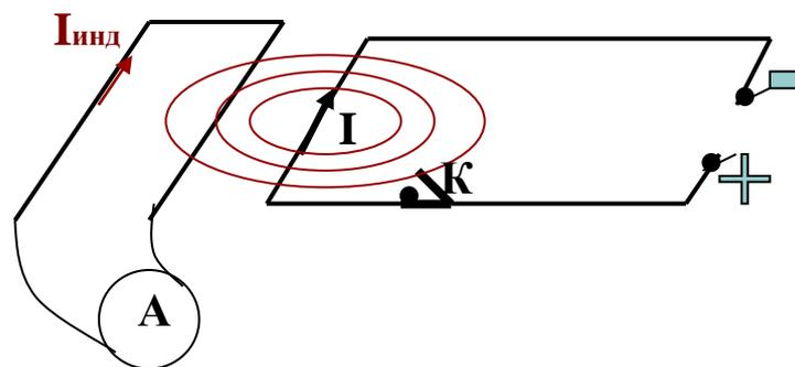
**Индукционный ток** в контуре возникает в момент включения и выключения ключа К
