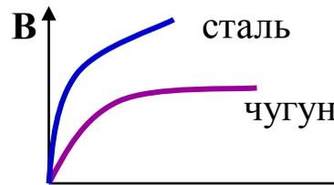
Сначала индукция  $B$  быстро увеличивается, но по мере намагничивания магнетика, индукция достигает максимального значения –
