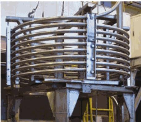
Одним из примеров эффективного использования низкотемпературных сверхпроводящих кабелей на основе NbTi является совместная разработка и изготовление сверхпроводящей катушки на основе NbTi для термоядерного реактора в рамках международного проекта ITER.
