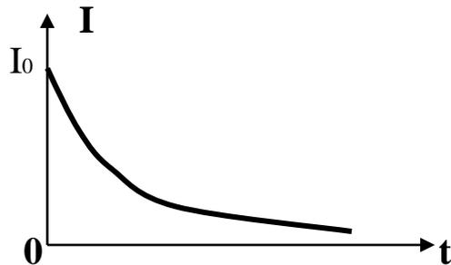
$\mathcal{E}_{is}$  стремится поддержать ток и оказывается приложенной к месту разрыва цепи. Она может быть так велика, что воздушный зазор пробивается газовым разрядом. Поэтому при разрыве силовых цепей, например рубильником, может возникнуть **электрическая дуга**.
