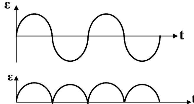
Переменное напряжение снимается с вращающегося витка с помощью щеток.
