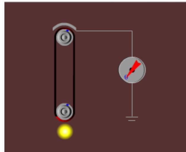
Нижний конец ленты проходит мимо электрода поддерживаемого обычным высоковольтным источником под высоким относительно земли напряжением до 100 кВ. В результате коронного разряда электроны с ленты переносятся на электрод
