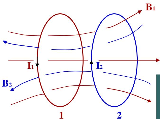
Часть силовых линий  $\mathbf{B}_1$ , создаваемых током  $\mathbf{I}_1$ , будут пронизывать контур  $\mathbf{2}$ , а часть силовых линий  $\mathbf{B}_2$ , создаваемых током  $\mathbf{I}_2$ , будут пронизывать контур  $\mathbf{1}$
