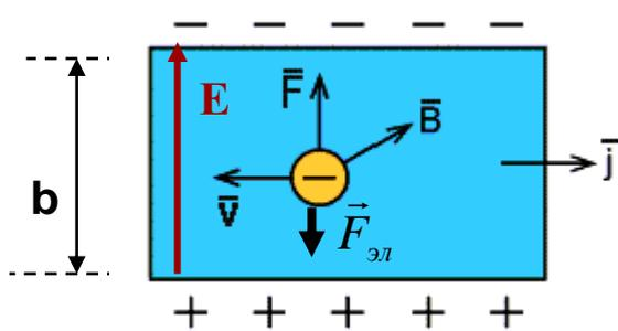
$b$  – толщина пластины,  $\vec{j}$  – плотность тока,  $\vec{B} \perp \vec{j}$
