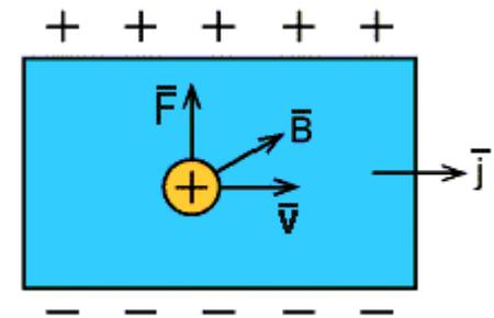
В дырочном полупроводнике знаки зарядов на поверхностях меняются на противоположные.
