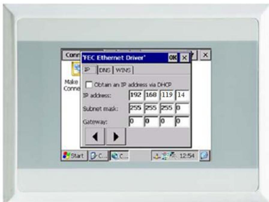
*Рис. 112. Сетевые настройки контроллера панели оператора*
