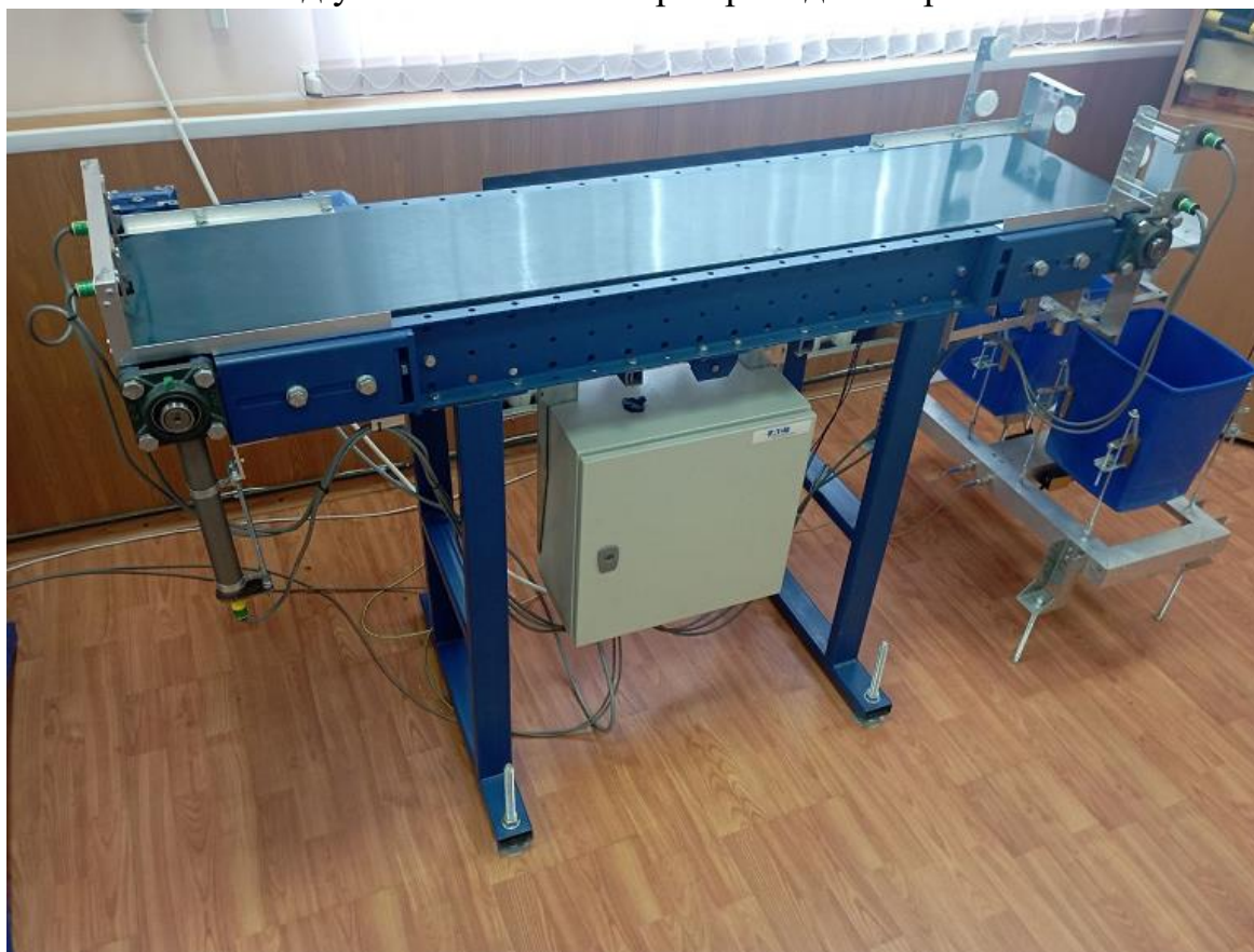
Рис. 20. Лабораторная установка конвейера
