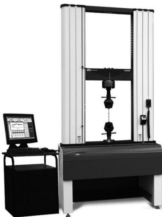
По этим данным строят первичную диаграмму растяжения, в которой по оси ординат откладывают усилия, а по оси абсцисс соответствующие им удлинения. Характер диаграммы растяжения зависит от свойств испытуемого материала:
