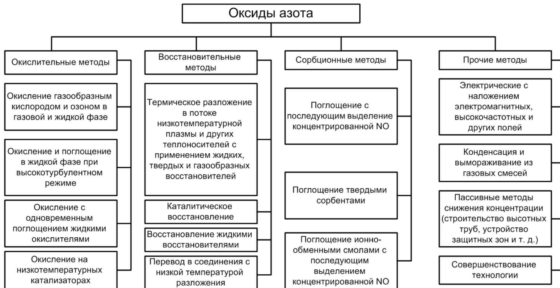
Рис. 1.63. Методы очистки промышленных газов от оксидов азота
