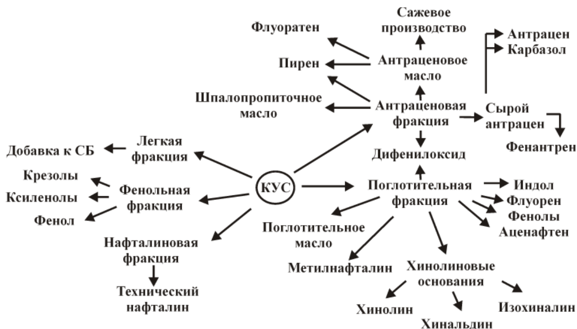
Рис. 5 Общая схема переработки фракций КУС
