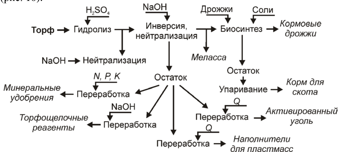
Рис. 10 Схема комплексной химической переработки торфа
