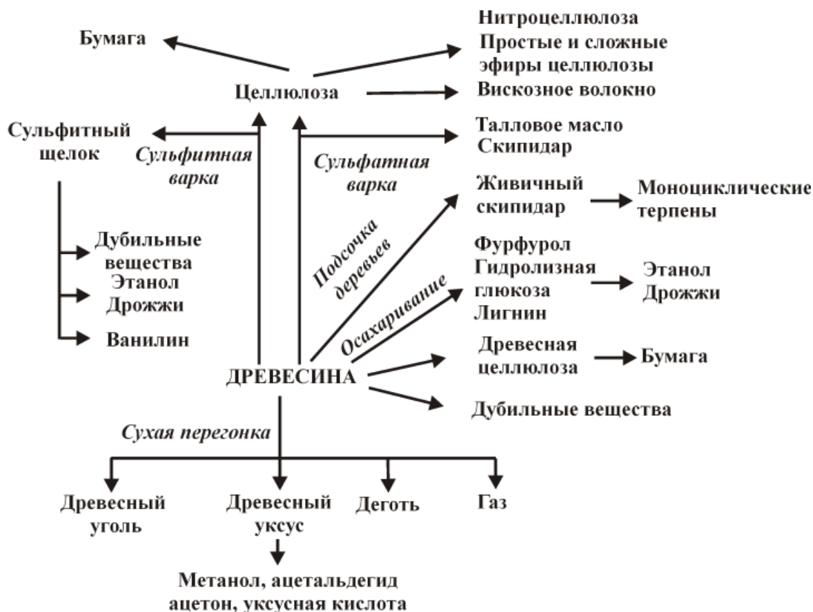
Рис. 2. Химические продукты, получаемые из древесины
