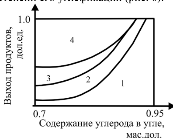
Рис. 6. Зависимость выхода жидких и газообразных продуктов от углефикации сырья: 1 – нерастворимый остаток, 2 – пек, 3 – пирогенетическая вода, 4 – жидкие продукты и газ
