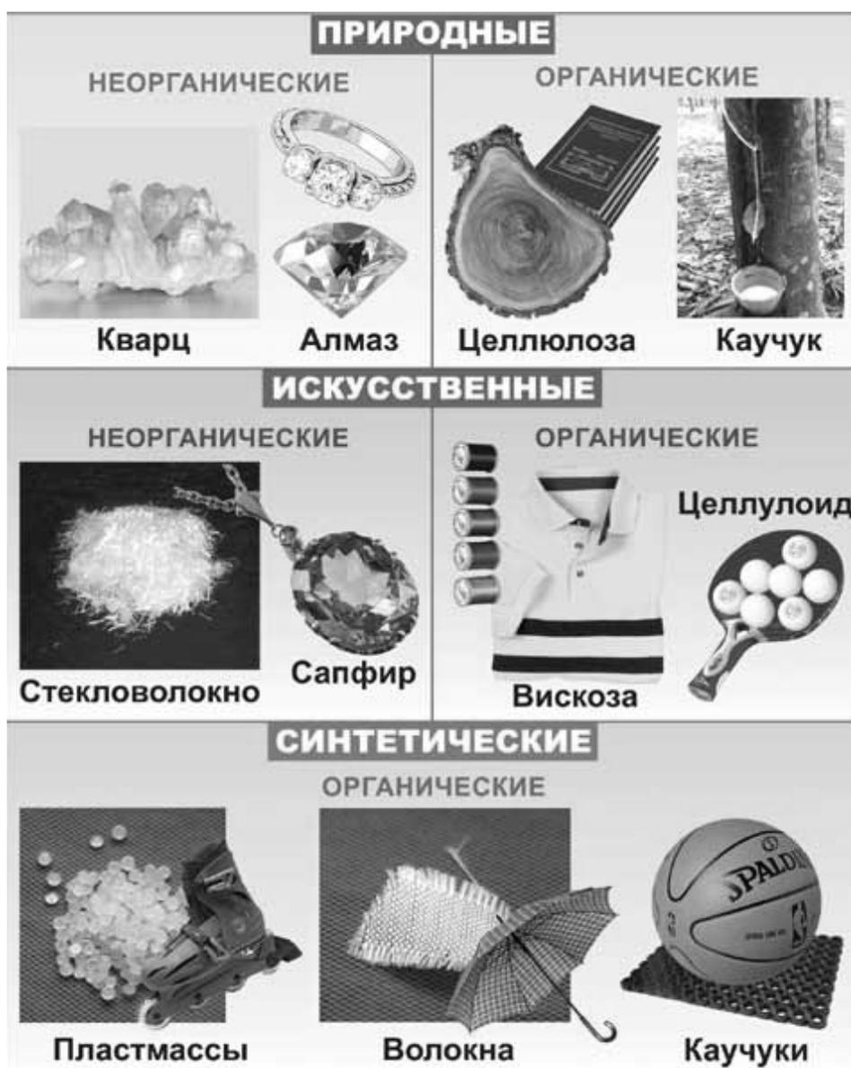
Рис. 15. Классификация полимеров и полимерных материалов
