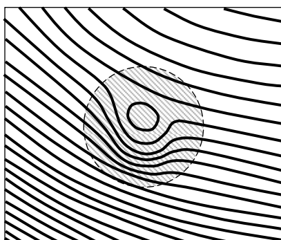
Рис.9.11. Голографическое изображение фрагмента объекта с зоной локальной деформации (выделена штриховкой)
