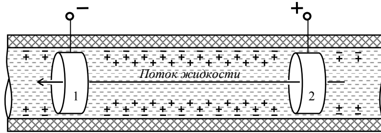
Рис. 3.21. Движение жидкости в капилляре под действием электрического поля: 1 – катод; 2 – анод
