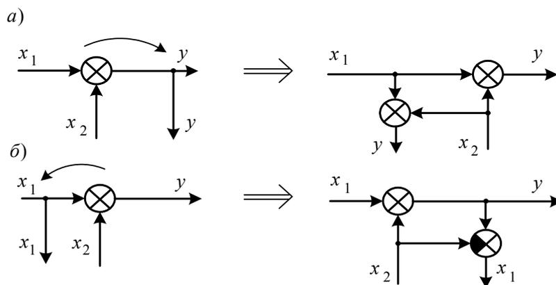
Рис. 8.11. Перенос сумматора через узел
