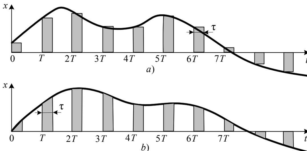
Рис. 2.4. Амплитудно-импульсная модуляция:
