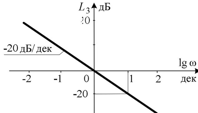
Рис. 7.3. ЛАЧХ  $L_3(\omega) = -20\nu \cdot \lg \omega$
