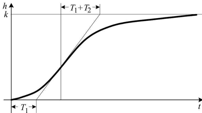
Рис. 9.33. Переходная функция апериодического звена второго порядка
