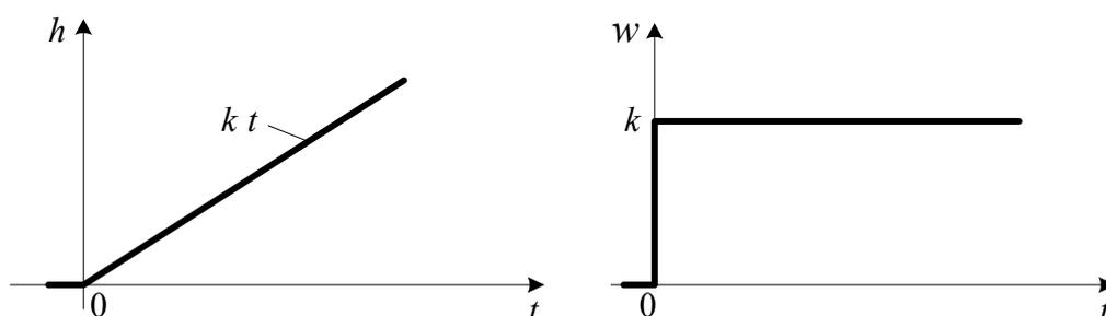
Рис. 9.2. Переходная и весовая функции интегрирующего звена
