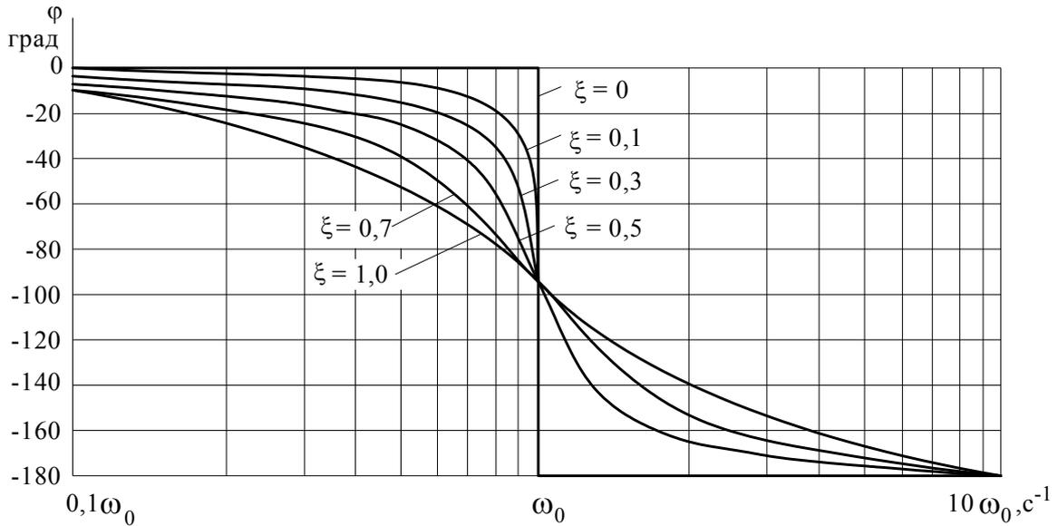
Рис. 9.32. Фазовые частотные характеристики звеньев второго порядка
