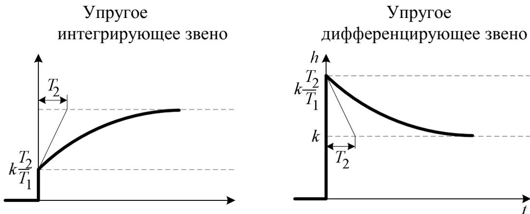
Рис. 9.27. Переходные функции упругих звеньев
