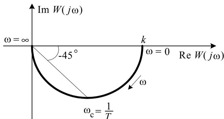
Рис. 9.19. Амплитудно-фазовый годограф устойчивого инерционного звена первого порядка
