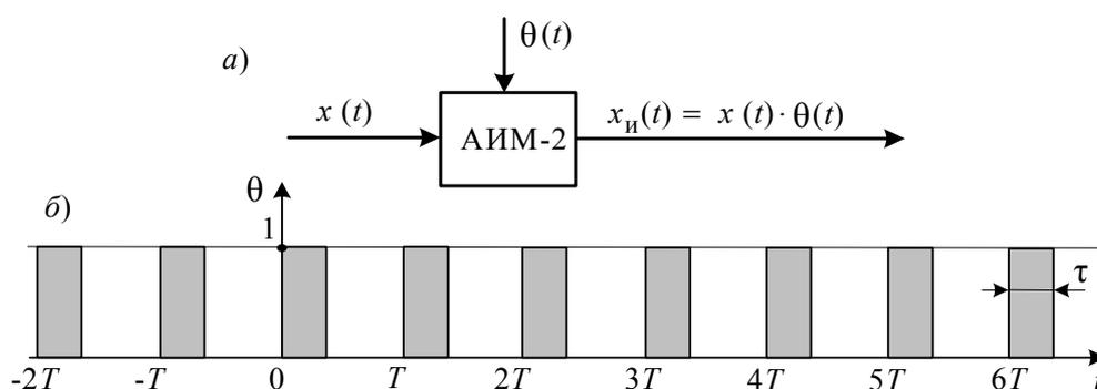
Рис. 2.5. Амплитудный модулятор: а – схема модулятора; б – импульсная последовательность на выходе
