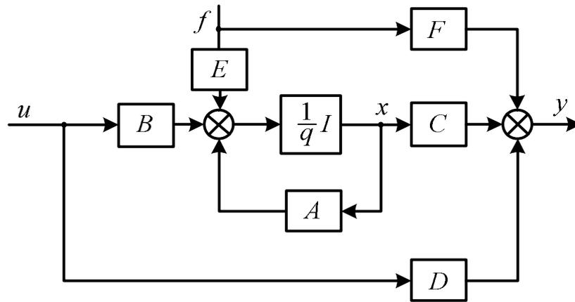
Рис. 8.19. Операторно-структурная схема модели ЛСОН-системы типа «вход-состояние-выход»
