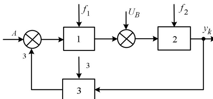
Рис. 6.6. Соединение с обратной связью и двумя входами
