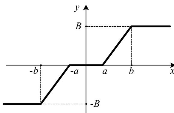
Рис. 9.14. Нелинейность типа «нечувствительность и ограничение»
