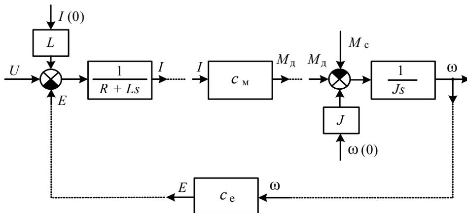
Рис. 8.7. Операторно-структурная схема электродвигателя постоянного тока с независимым возбуждением
