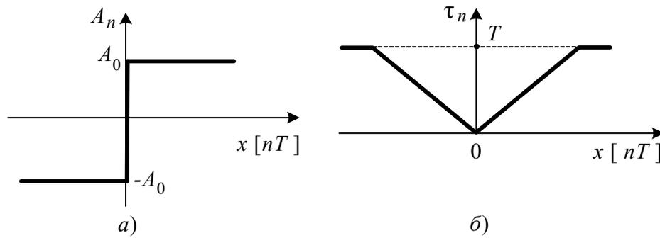
Рис. 2.9. Виды амплитудных характеристик ШИМ:
