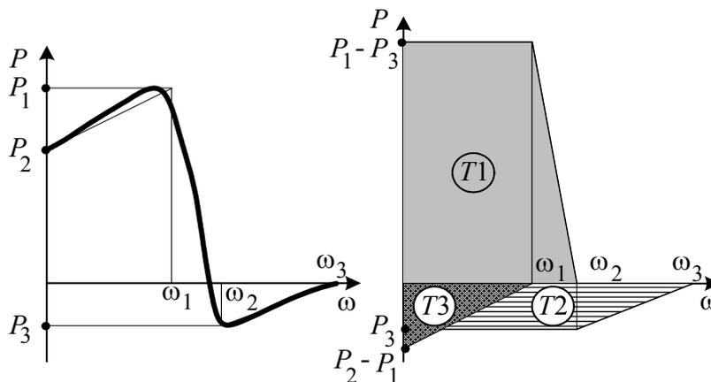
Рис. 10.2. Аппроксимация вещественной частотной характеристики трапециями
