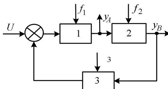
Рис. 6.8. Соединение с обратной связью и двумя выходами
