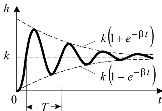
Рис. 9.34. Переходная функция устойчивого колебательного звена второго порядка
