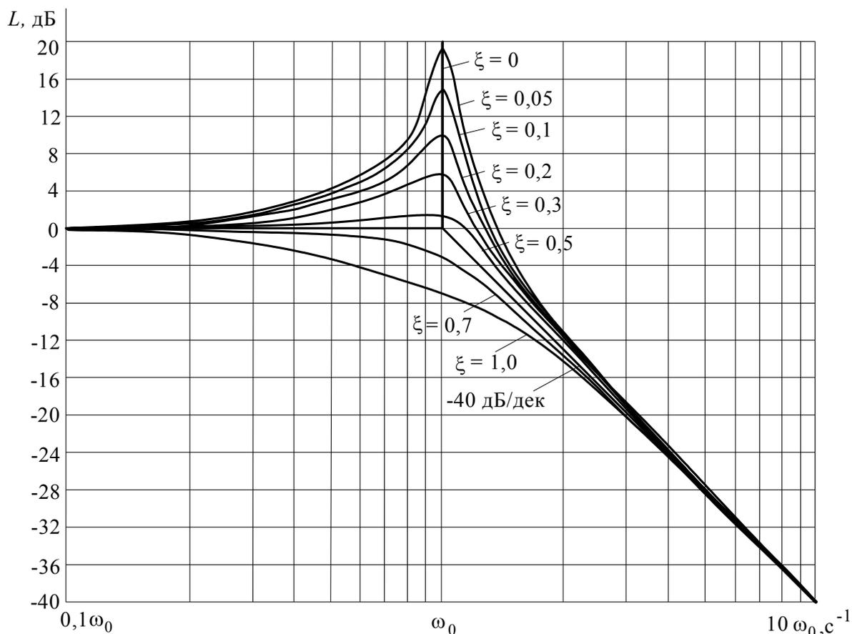
Рис. 9.31. Логарифмические амплитудные частотные характеристики звеньев второго порядка
