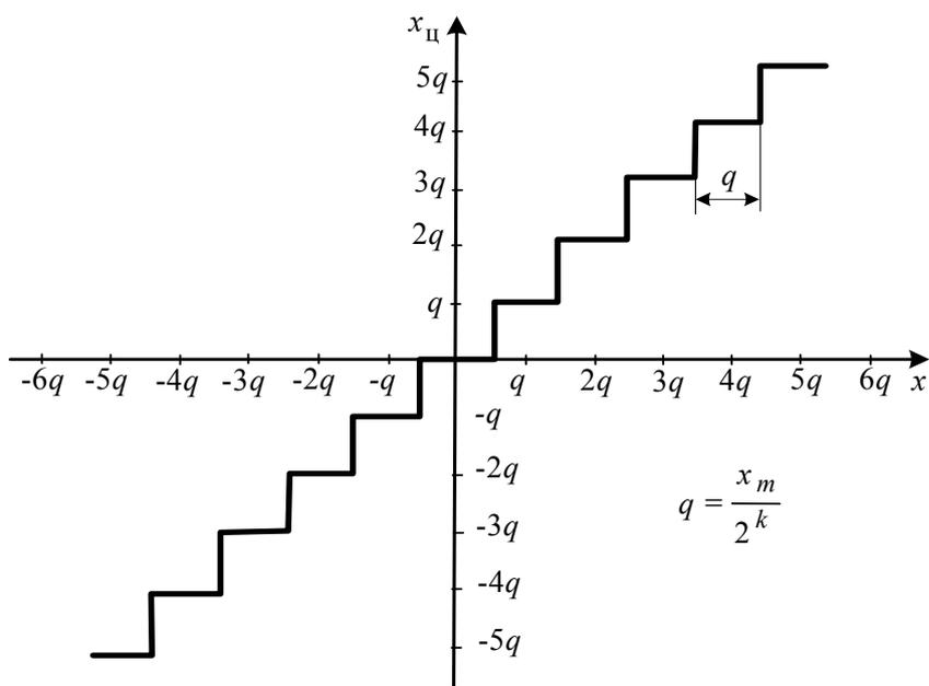
Рис. 2.1. Вход-выходная характеристика аналого-цифрового квантователя
