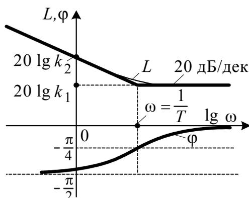
Рис. 9.6. Логарифмические частотные характеристики пропорционально-интегрирующего звена
