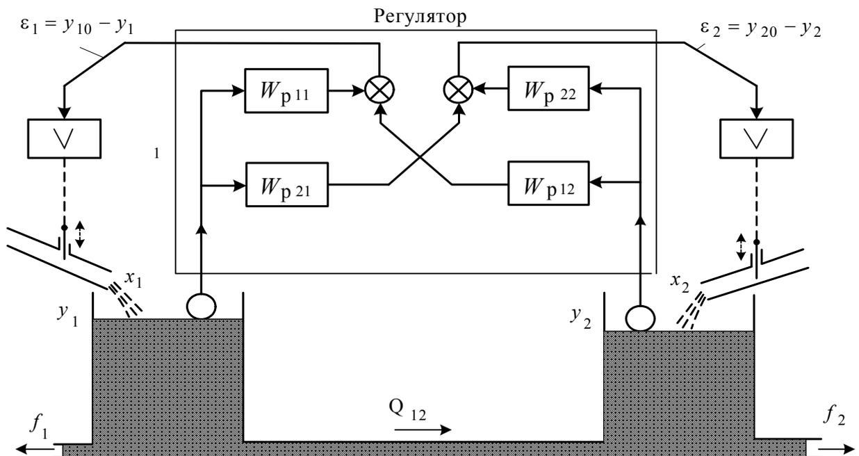
Рис. 8.17. Системы автоматической стабилизации уровней жидкости в двух сообщающихся между собой резервуарах
