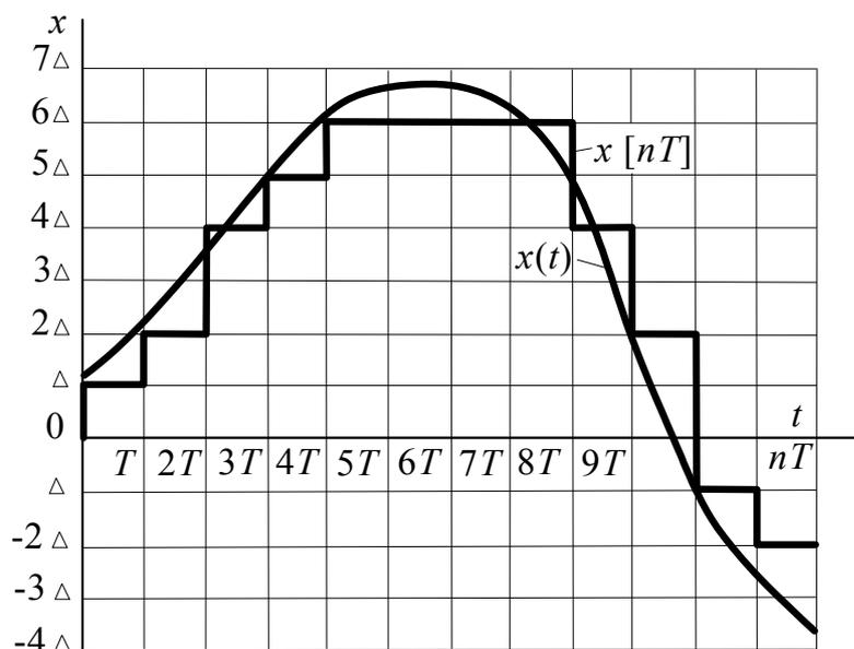
Рис. 2.10. Аналого-цифровое преобразование
