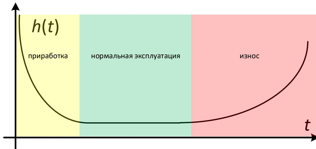
В период нормальной эксплуатации интенсивность отказов имеет приблизительно постоянное значение.
