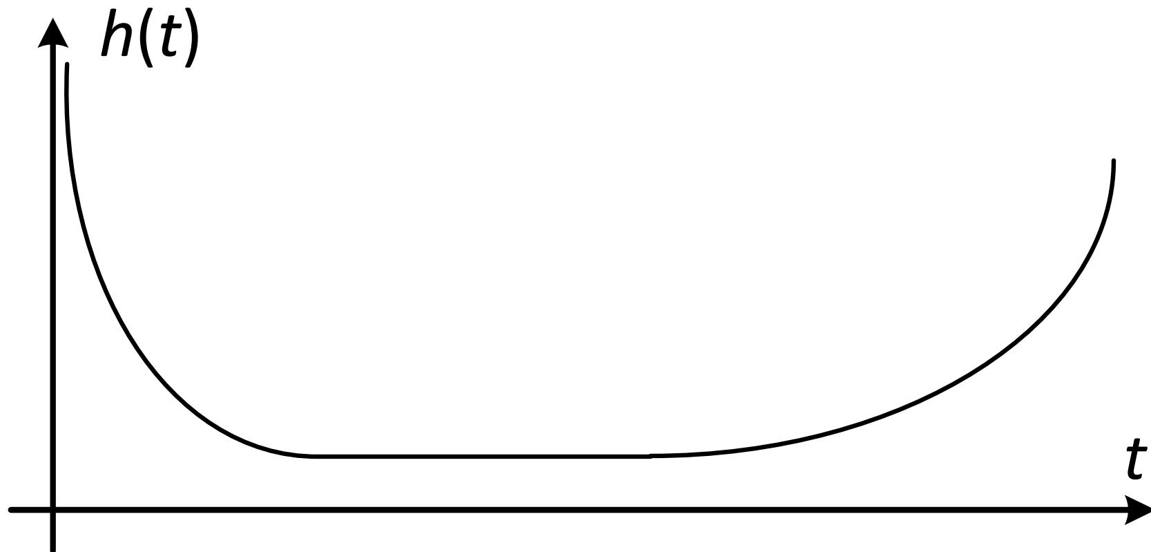
В соответствии с формой кривой интенсивности отказов можно выделить три периода жизненного цикла изделия:
