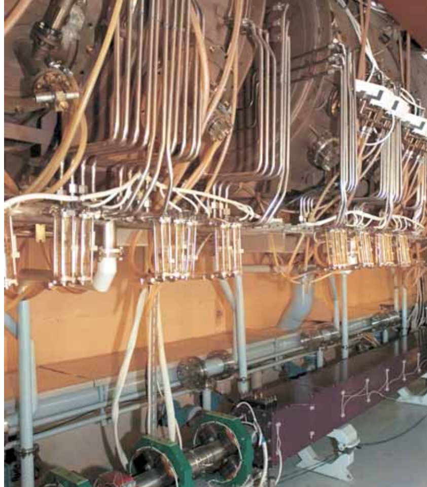
Первая очередь установки с ЛСЭ, запущенная в апреле 2003 г., в отличие от полномасштабного варианта имеет единственный канал транспортировки электронов
