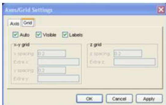
Рис. 3.2.1.4. Параметры настройки Сетки в диалоговом окне Axes/Grid Settings
