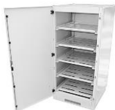
Батарейный кабинет АП1802 (885 × 877 × 1802) 5 полок по 8 батарей 100 Ач
