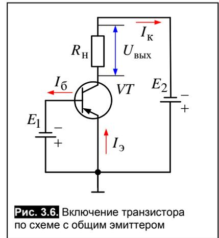
Рис. 3.6. Включение транзистора по схеме с общим эмиттером
