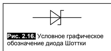
Рис. 2.16. Условное графическое обозначение диода Шоттки
