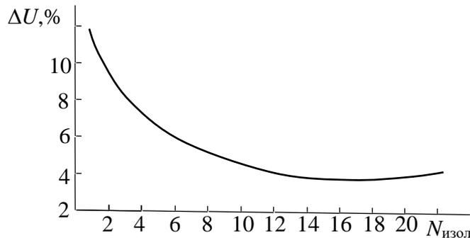
Рис. 2. Распределение напряжения (в %) вдоль гирлянды из изоляторов ПС-12 линии класса 500 кВ
