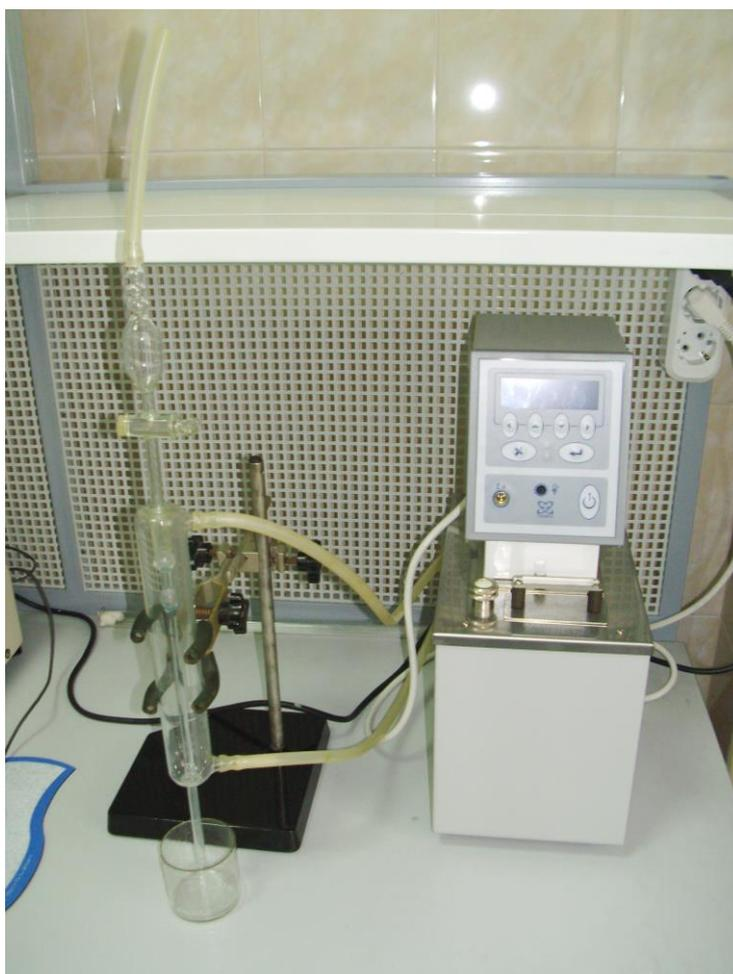
Рисунок 15 – Установка для определения молекулярного веса полимера вискозиметрическим методом
