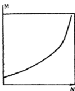
Рис. 37. Зависимость мутности M от числа оборотов N шнека при экструзии рукавной пленки из ПЭНП
