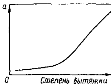
Рис. 22.9. Зависимость ударной вязкости a изделий из УПС от степени вытяжки листа при формовании
