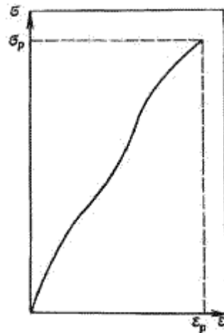
Рис. 23. Диаграмма «напряжение — деформация» полимерных образцов с высокоразвитой ориентированной структурой
