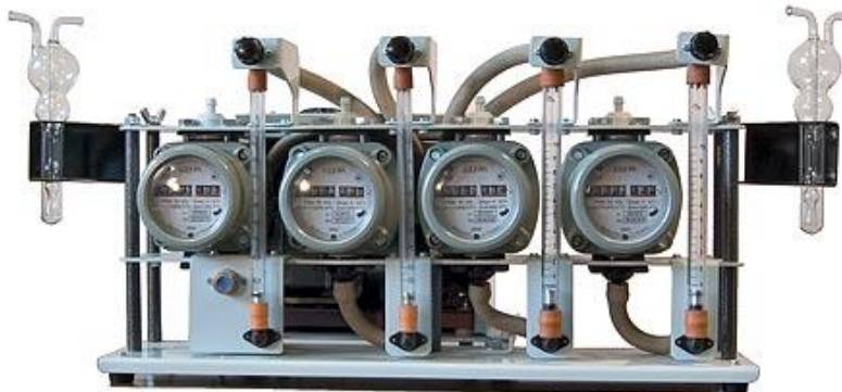
Рис. 32. Устройство отбора проб воздуха (пробоотборник) УОПВ-4
