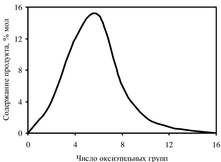
Рис. 27. Кривая распределения оксиэтилированных неионных ПАВ по числу оксиэтильных групп
