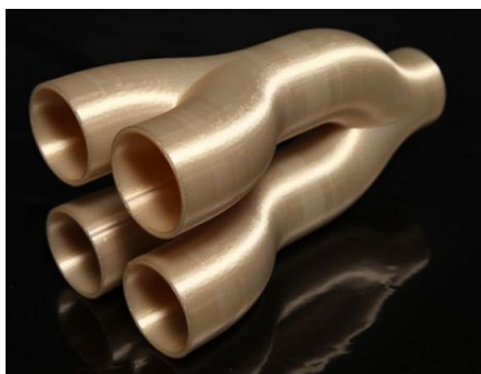
Рис. 15 – Модель, напечатанная 3D принтером с технологией FDM печати
