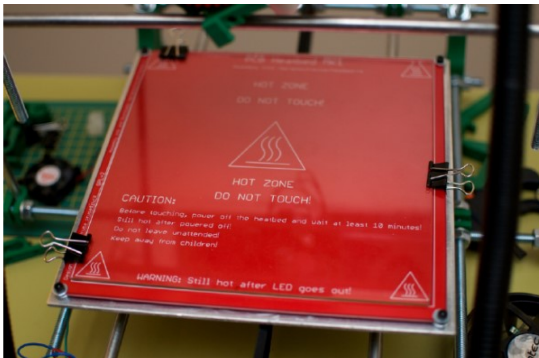
Рис. 18 – Подогреваемая платформа, накрытая съемным стеклянным рабочим столиком
