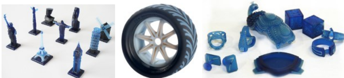
Рисунок 55 – Примеры моделей, созданных по технологии MJM
