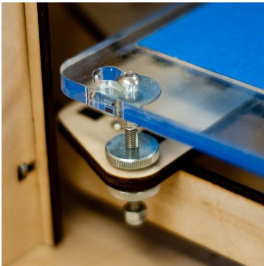
Рис. 19 – Калибровочный винт рабочей платформы
