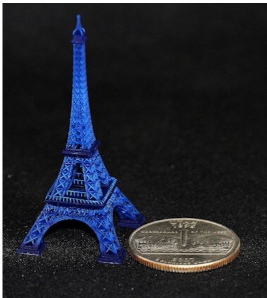
Рис. 35 – Пример модели, напечатанной на лазерном SLA 3D-принтере
