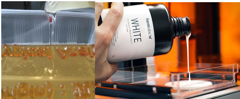
Рис. 34 – Фотополимерная смола заливается в кювету
