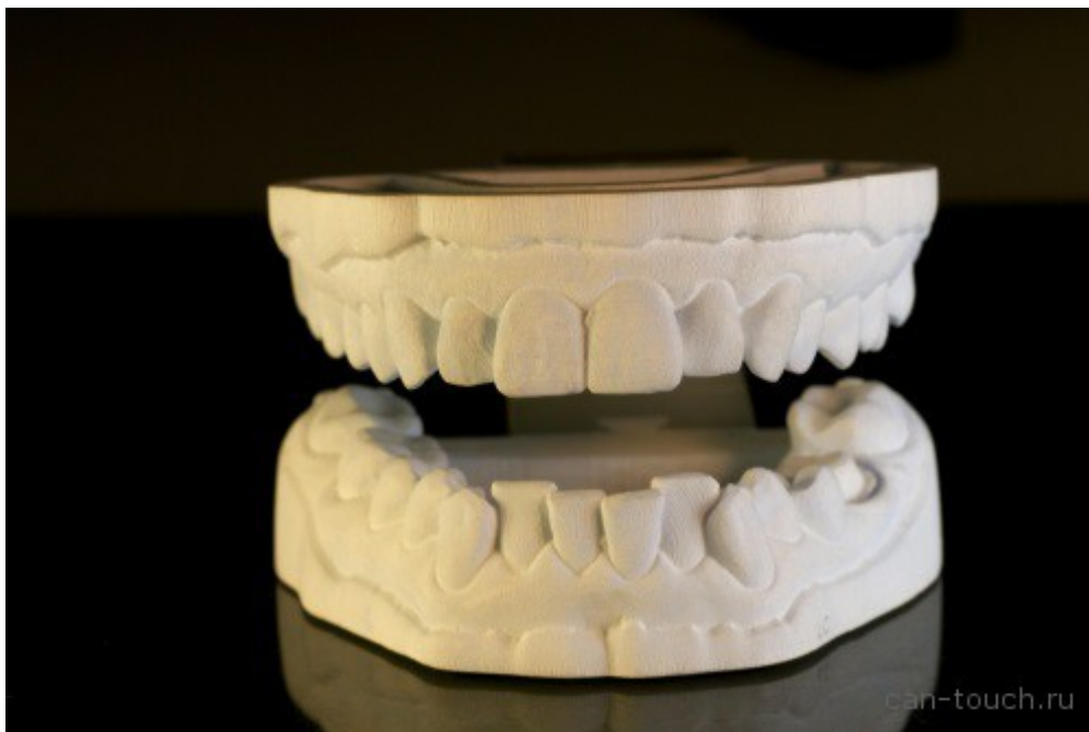
Рисунок 56 – VisiJet Pearlstone - материал, применяемый для создания стоматологических мастер-моделей
