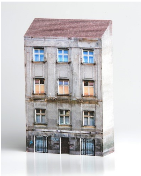
Рисунок 48 – Макет здания, изготовленный по LOM-технологии
