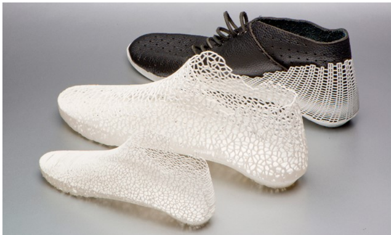
Рис. 38 – Компания New Balance использует технологию SLS при создании обуви для профессиональных атлетов
