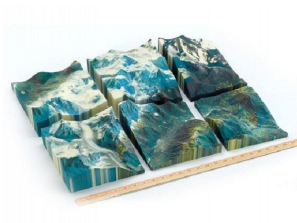
Рисунок 46 – Применение LOM-технологии для изготовления макетов
