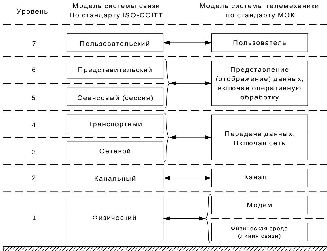
Рисунок 2.1 Модель системы связи по стандарту «ISO-CCITT»
