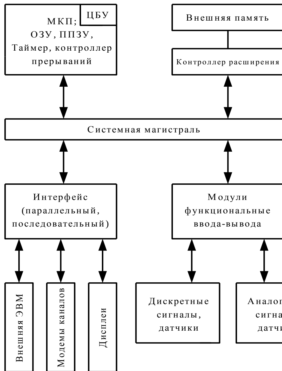
Рисунок 12.1 Структурная схема телемеханического комплекса с единой системной магистралью
