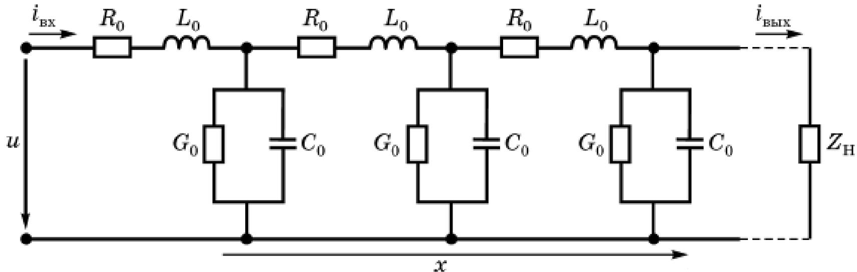
**Однородной** называют **длинную** линию, параметры которой (сопротивление, индуктивность, проводимость изоляции и емкость) распределены вдоль провода равномерно (неизменны по всей длине линии).
