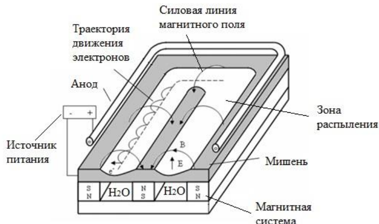
Рисунок 1.1 – Схема магнетронной распылительной системы с плоской мишенью [3]
