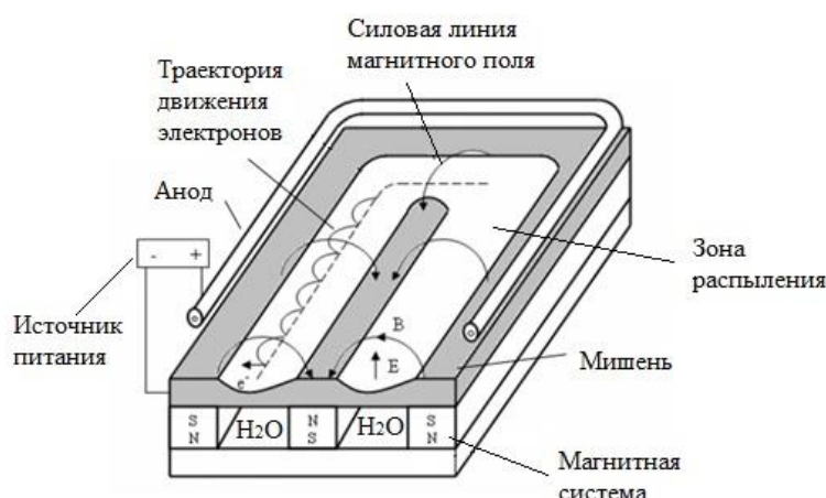
Рисунок 1.1 – Схема магнетронной распылительной системы с плоской мишенью [3]
