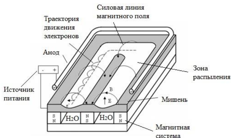
Рисунок 1.1 – Схема магнетронной распылительной системы с плоской мишенью [3]
