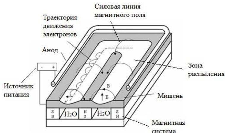
Рисунок 1.1 – Схема магнетронной распылительной системы с плоской мишенью [3]
