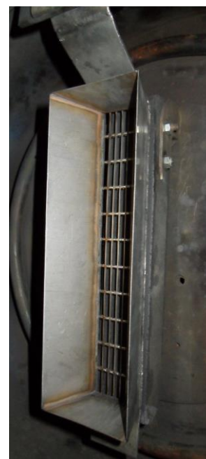
Рис. 17. Схема диодного узла и фотография плоского полоскового диода: потенциальный электрод диода (1), заземленный электрод (2), колимированный цилиндр Фарадея (3), пояс Роговского (4)
