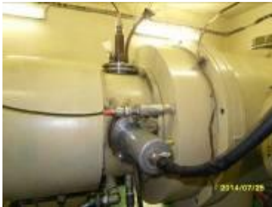
Рис. 93. Фото блока формирования импульса запуска и управляющего электрода тригatrona
