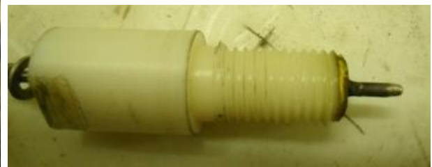
Рис. 93. Фото блока формирования импульса запуска и управляющего электрода тригatrona
