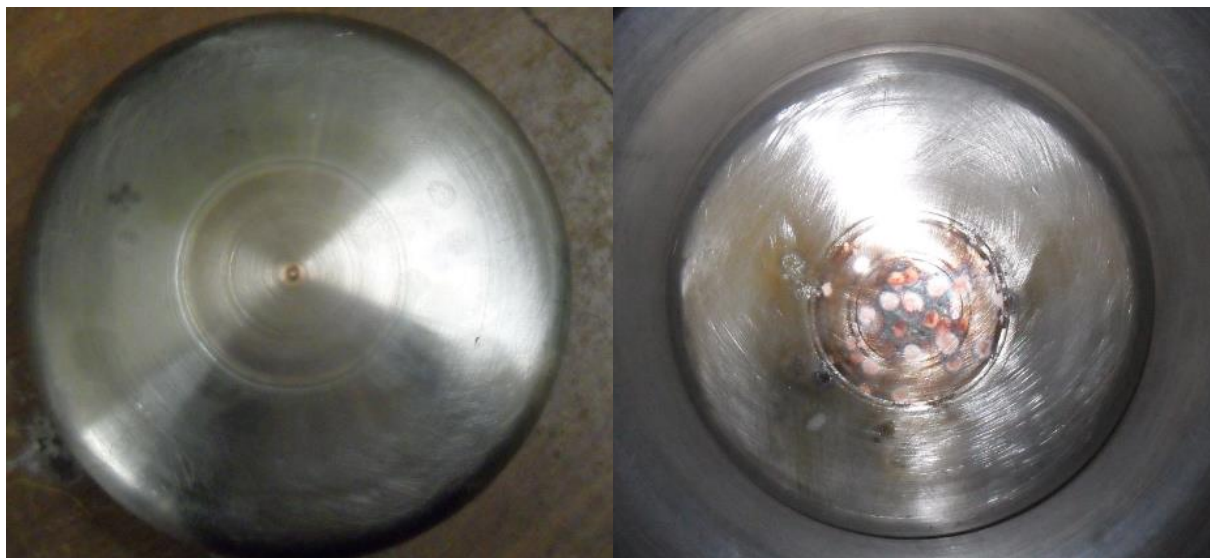
Рис. 87. Фото электрода основного разрядника с киритовой вставкой до и после работы в разряднике
