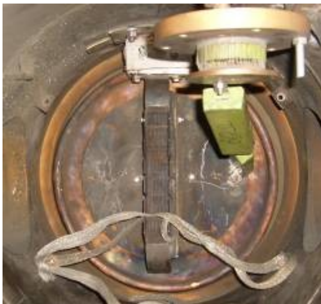
Рисунок 23 – Фотография фокусирующего диода с заземлением полоска в нескольких точках
