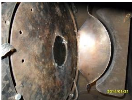
Рисунок 39 – Фотография фокусирующего диода и коллектора ЦФ, закрытого фольгой, для измерения электронного тока.
