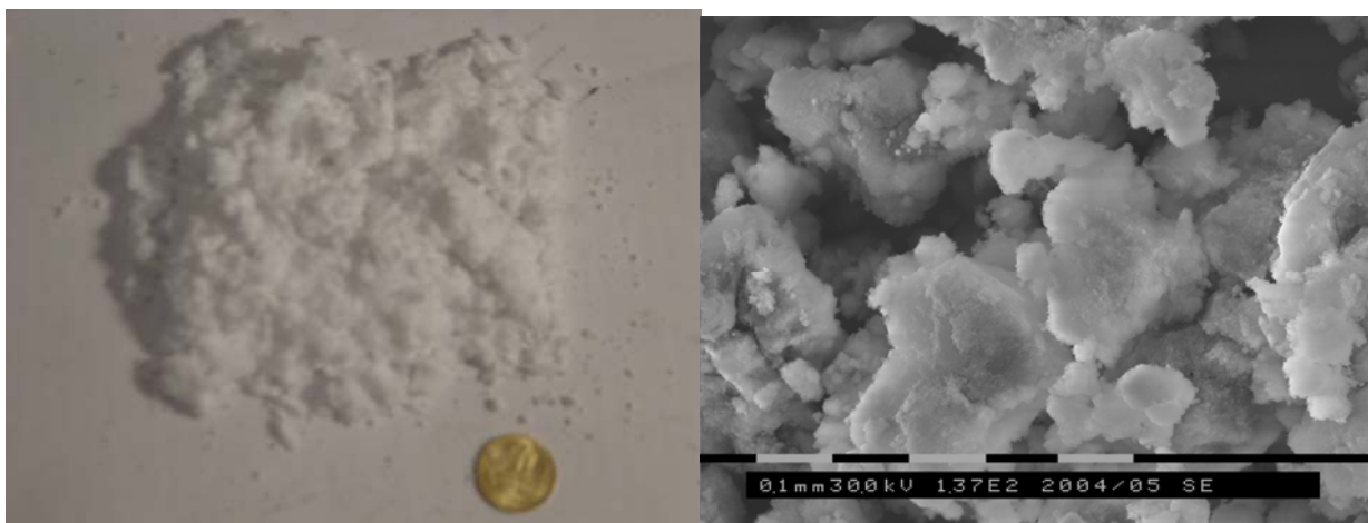
Рис. 110. Внешний вид и фотография синтезированного композиционного оксида, полученная на сканирующем электронном микроскопе.
