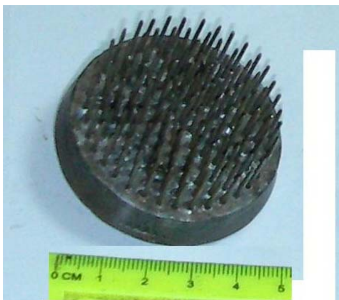
Рис. 26. Фото многоострийного катода с вольфрамовыми иглами.
