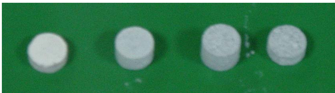
Рис. 121. Фотография компактированного композиционного порошка (\text{TiO}_2)_x(\text{SiO}_2)_{1-x} с разным содержанием кремния и титана.
