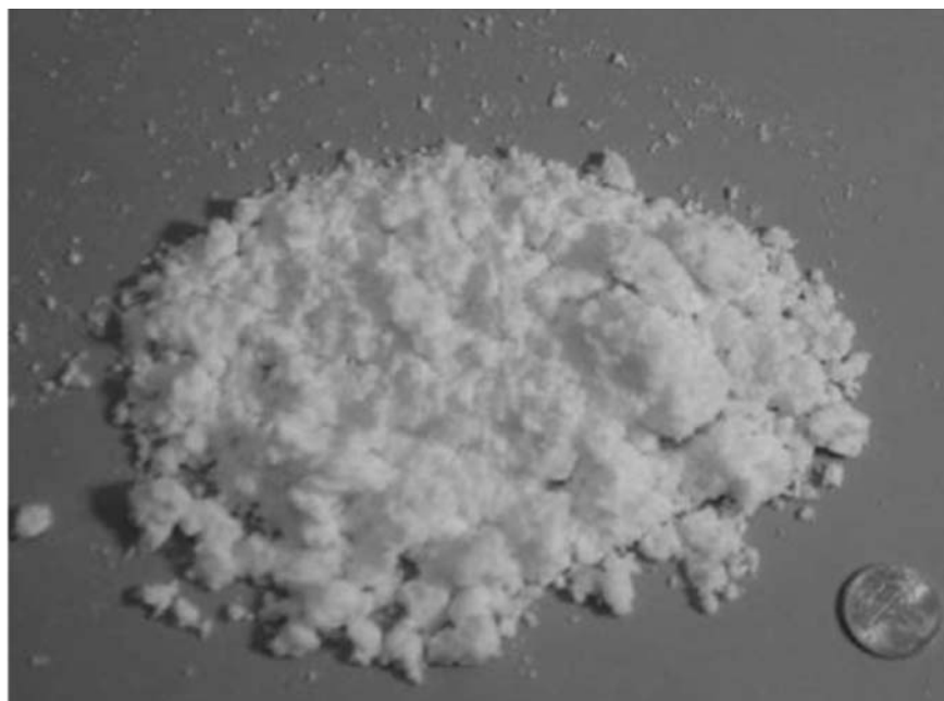
Рис. 5.44. Внешний вид синтезированного диоксида титана.
