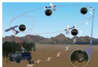
Рис. 4 Схема работы системы LaserMotive для поддержки беспилотного аппарата
