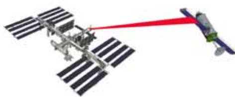
Рис. 6 Схематичный рисунок схемы беспроводной передачи энергии между МКС и КА
