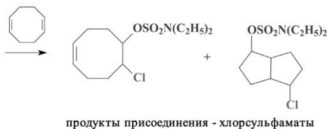
Рис.5. Присоединение N,N-диэтилхлорамина к циклооктадиену с образованием хлорсульфаматов. Красным цветом показан электрофильный, синим - нуклеофильный фрагмент реагента.
