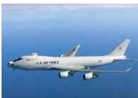
Рис. 5. Военные приложения БПЭ ( а) Боинг YAL-1 — экспериментальный боевой самолёт, способный с помощью бортового лазера уничтожать объекты противника; б) Корабельная лазерная система Raytheon
