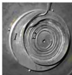
Рис.3. Фотография проволочного диода: потенциальный электрод (1), заземленный электрод (2). Термограмма ионного пучка, формируемого проволочным диодом
