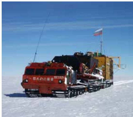
Рис.2. Наземная передвижная геофизическая лаборатория «Витязь»
