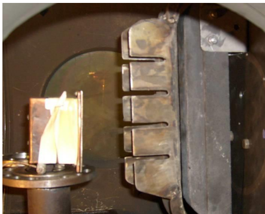
Рисунок 117. Схема измерения параметров МИП, формируемого плоским диодом
