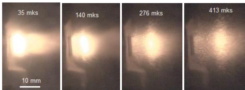
Рисунок 105. Динамика абляционной плазмы
