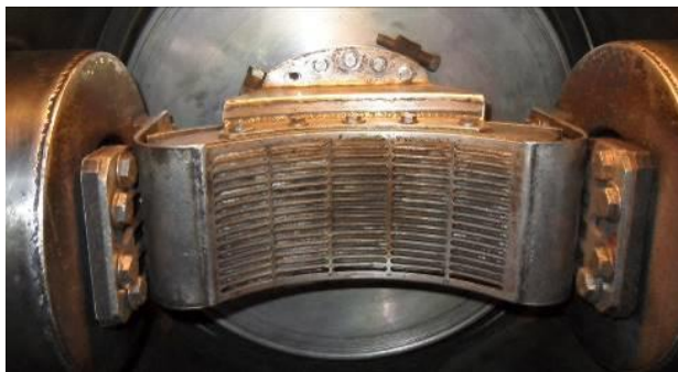
Рисунок 27. Фотография фокусирующего полоскового диода с внешней магнитной изоляцией
