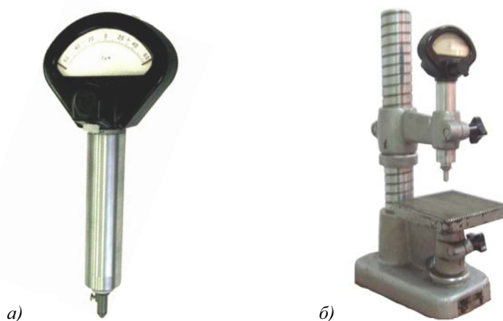
Рис. 8.45. Микрокатор: а) 2ИГП ГОСТ 6933–81. б) установленный на стойке
