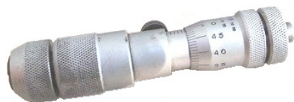
Рис. 8.19. Нутромер микрометрический НМ 75–0,01 ГОСТ 10–80
