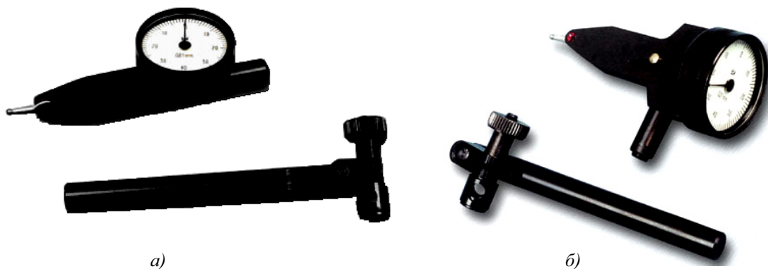
Рис. 8.44. Индикаторы рычажно–зубчатые: а) ИРБ ГОСТ 5584–75, б) ИРТ ГОСТ 5584–75
