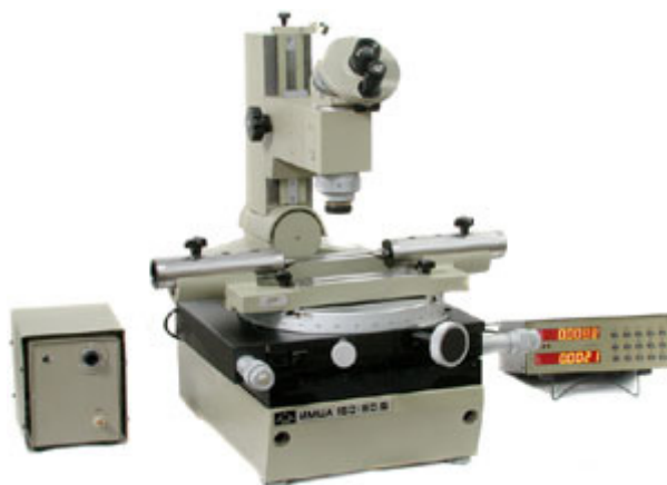
Рис. 8.47. Большой микроскоп инструментальный БМИ-1Ц (ИМЦ 150x50 Б)
