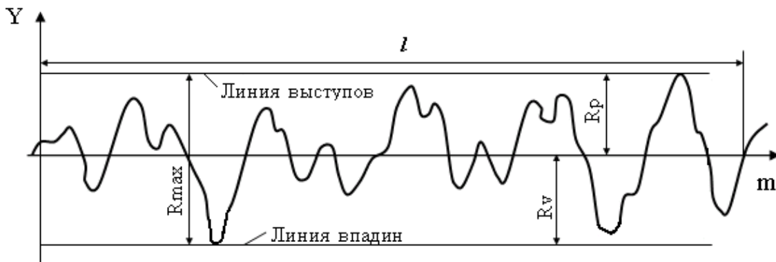
Рис. 5.4. Наибольшая высота неровностей профиля ( R_{max} )
