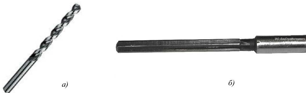
Рис. 2.22. Инструмент для изготовления отверстий, а) сверло; б) развертка
