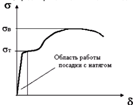
Рис. 2.17. Зависимость напряжений от деформаций, σВ – предел прочности материала, σТ – предел текучести материала
