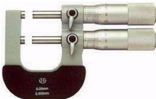
Рис. 8.23. Микрометр предельный МКПр 25
