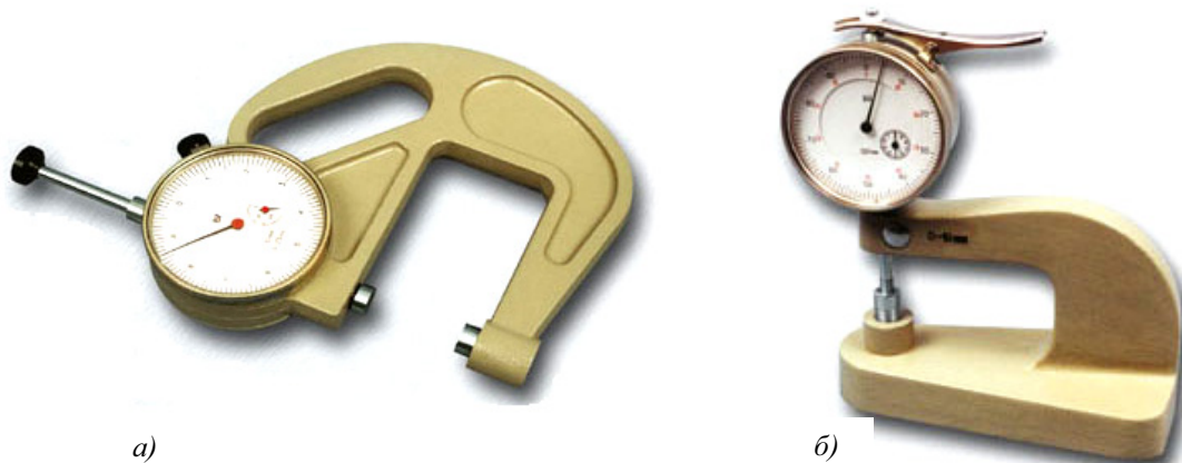
Рис. 8.42. Толщиномеры индикаторные: а) ТР-25-60Б ГОСТ 11358-89, б) ТН-10-60 ГОСТ 11358-89
