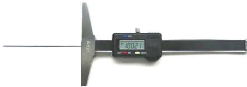
Рис. 8.8. Цифровой штангенглубиномер с тонким измерительным стержнем
