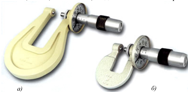
Рис. 8.13. Микрометры листовые: а) МЛ 25 ГОСТ 6507-90, б) МЛ 10 ГОСТ 6507-90
