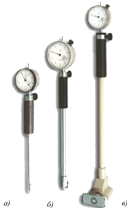
Рис. 8.40. Нутромеры индикаторные: а) НИ 10–18–1 ГОСТ 868–82, б) НИ 18–50 –1 ГОСТ 868–82, в) НИ 100–160 –1 ГОСТ 868–82
