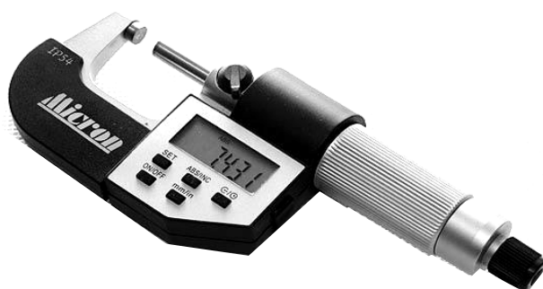
Рис. 8.24. Микрометр гладкий МКЦ 25 ГОСТ 6507-90
