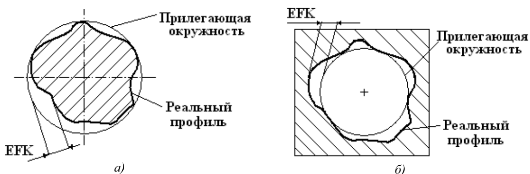
Рис. 6.7. Отклонение от круглости при отсчете от:
