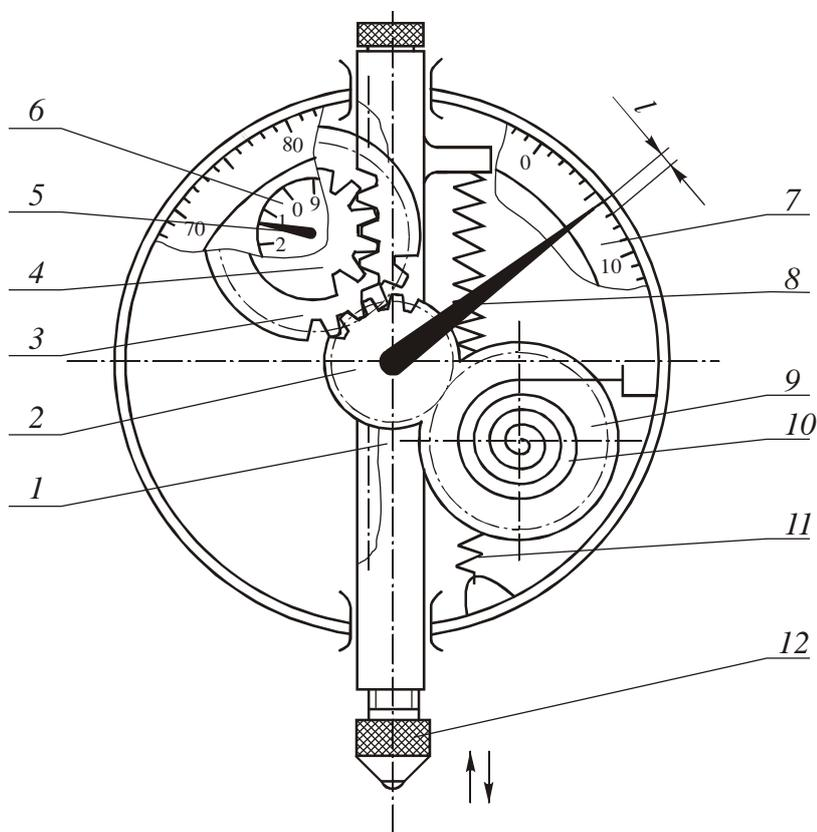
Рис.1. Индикатор часового типа ИЧ-10
