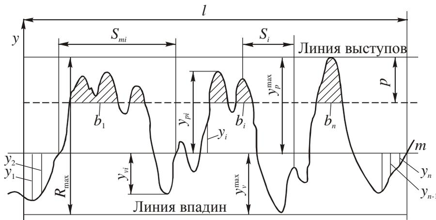
Рис. 1. Профилограмма и основные параметры шероховатости поверхности
