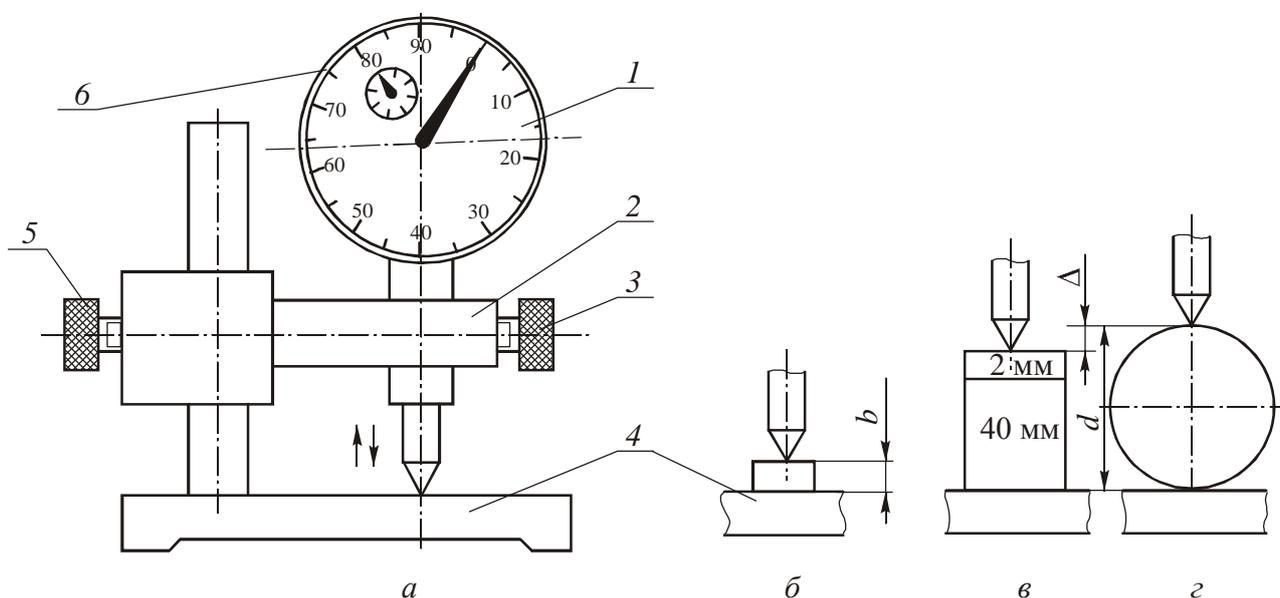
Рис.2. Измерение индикатором
