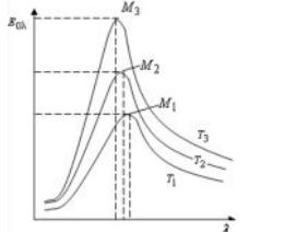
$\lambda$  - длина волны, м;  $T$  - абсолютная температура тела, К;  $C_1, C_2$  - константы:  $C_1 = 3,74 \cdot 10^{-16}$  Вт·м<sup>2</sup>;  $C_2 = 0,0144$  М·К.
