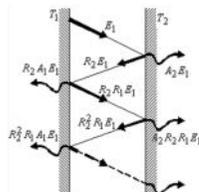
Рис. 6.5. Теплообмен излучением между параллельными поверхностями
