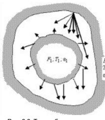
Рис. 6.6. Теплообмен излучением между телом и его оболочкой
