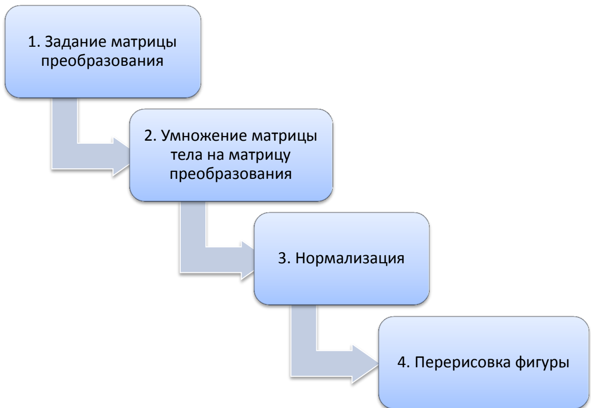
Рис. 9.2. Основной процесс визуализации
