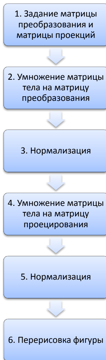
Рис. 10.4. Процесс визуализации трехмерного тела
