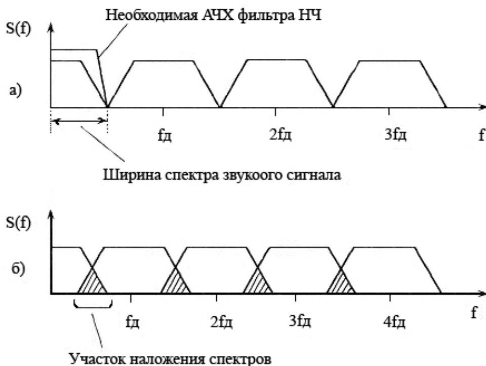
Рис. 4.2. Перекрывание спектров сигнала при дискретизации
