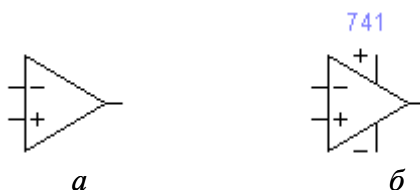
Рис. 2.26. Модели операционных усилителей. а – идеальный, без выводов питания; б – серийный, с выводами питания
