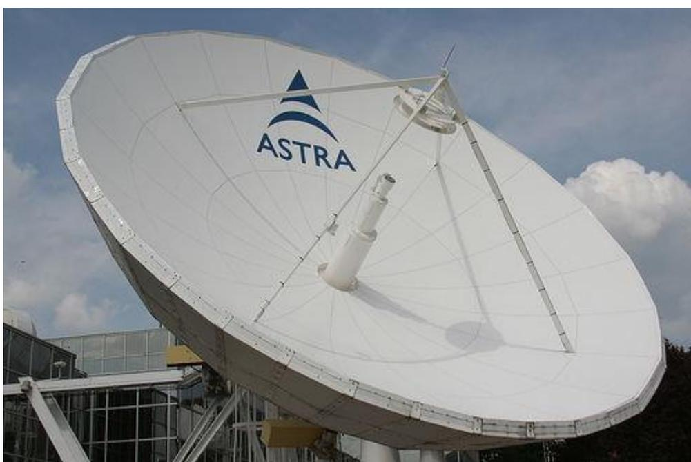
*Рис. 31. Внешний вид прямофокусной спутниковой антенны*
