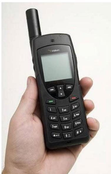
*Рис. 45. Спутниковой телефон модель 9555 компании Iridium*
