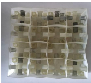
Рисунок 4. Образец АММ структуры, состоящей из 16 ячеек, связанных через цилиндрические трубки с открытыми торцами, изготовленный по технологии PolyJet без искажения формы (слева) и эффект коробления (справа)
