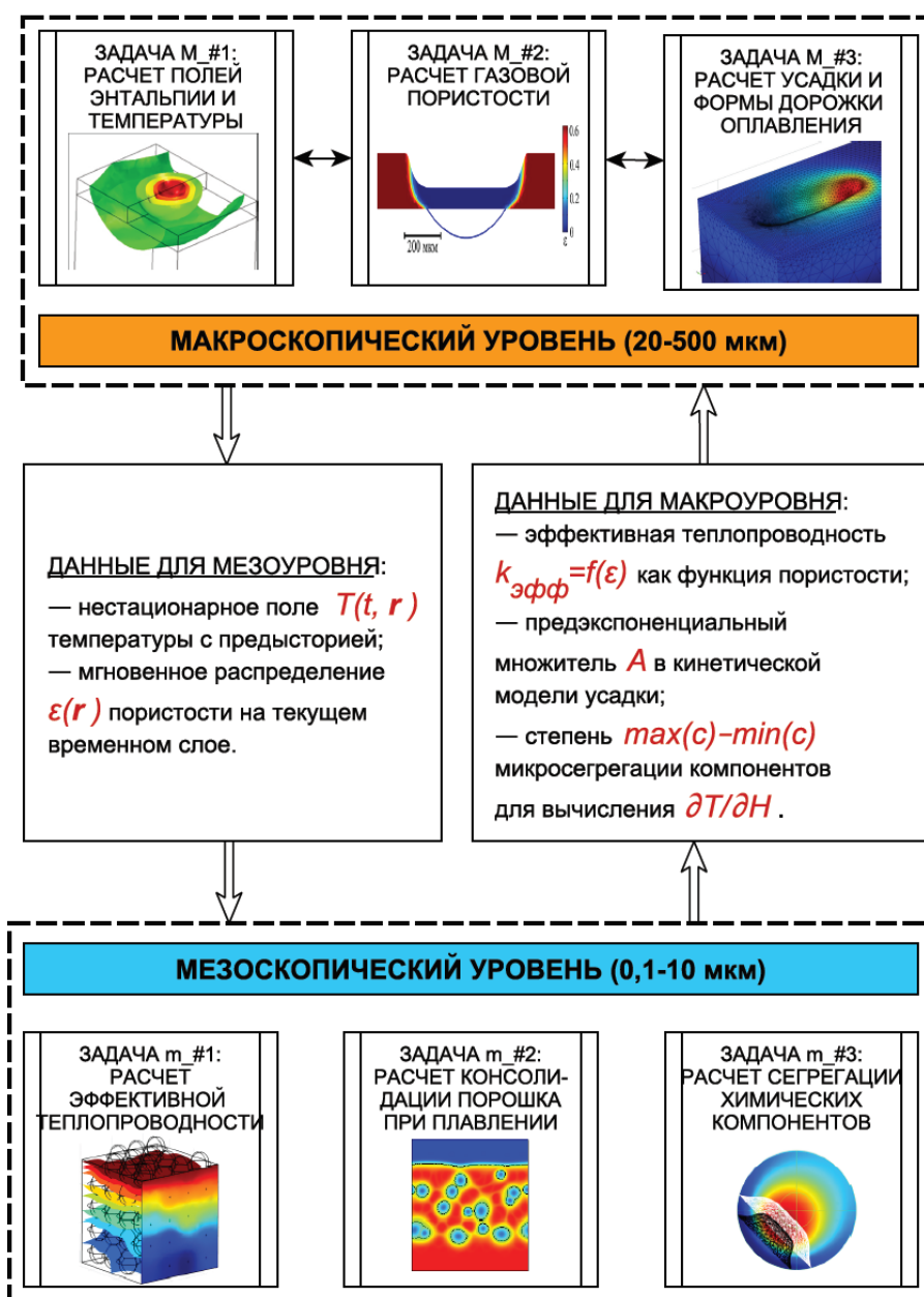
Рисунок 2. Схема согласования решений на макроscopicком и мезоскопическом уровнях в задаче расчета селективного лазерного плавления
