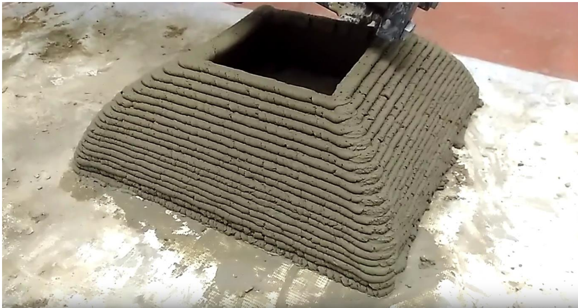
Рисунок 3. Попытка печати с отклонением 60 градусов от вертикали
