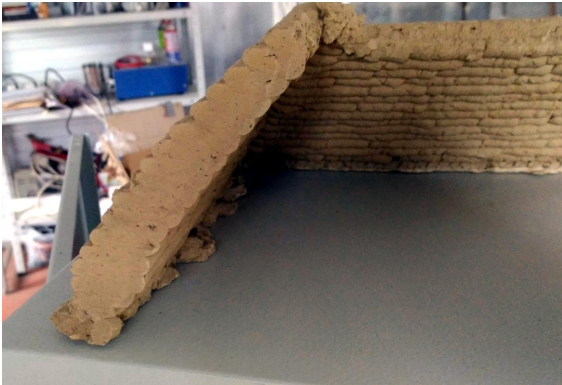
Рисунок 2. Напечатанная стенка в разрезе
