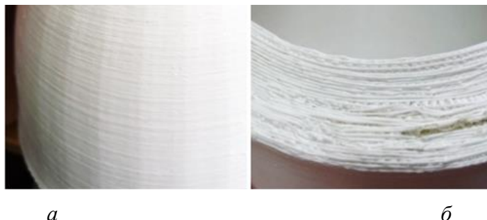
Рисунок 2. Сопоставление результатов 3D-печати при температуре экструдирования 250 °C (а) и 275 °C (б).
