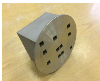
Рисунок 5 – АММ Образец из металла по технологии SLM (слева); лазерная сварка соединения 2-х элементов составной модели
