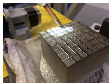
Рисунок 5 – АММ Образец из металла по технологии SLM (слева); лазерная сварка соединения 2-х элементов составной модели
