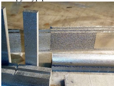
Рисунок 1. Вид плоских образцов для растяжения с различным типом ячеистых структур
