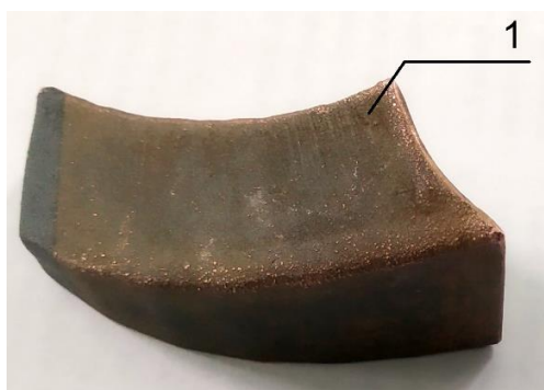
Рисунок 2. Комбинированный ЭИ с покрытием 1, используемый в экспериментальных исследованиях
