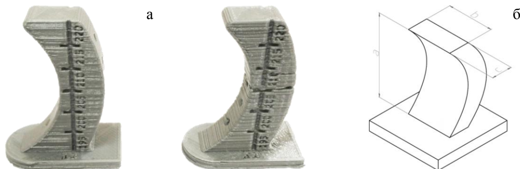
Рисунок 1. а - опытные образцы для определения коэффициента термоусадки моделей ЭИ (толщина нити 0,4 мм и толщина нити 0,8 мм), б – геометрические характеристики, которые контролировались для определения коэффициента термоусадки k_n
