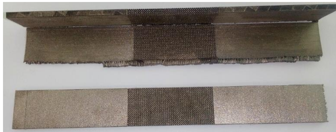
Рисунок 1. Вид плоских образцов для растяжения с различным типом ячеистых структур
